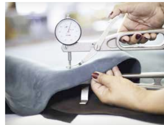
Mesure de l'épaisseur du cuir dans les ateliers Lemaitre Measuring the thickness of the leather in Lemaitre workshops
